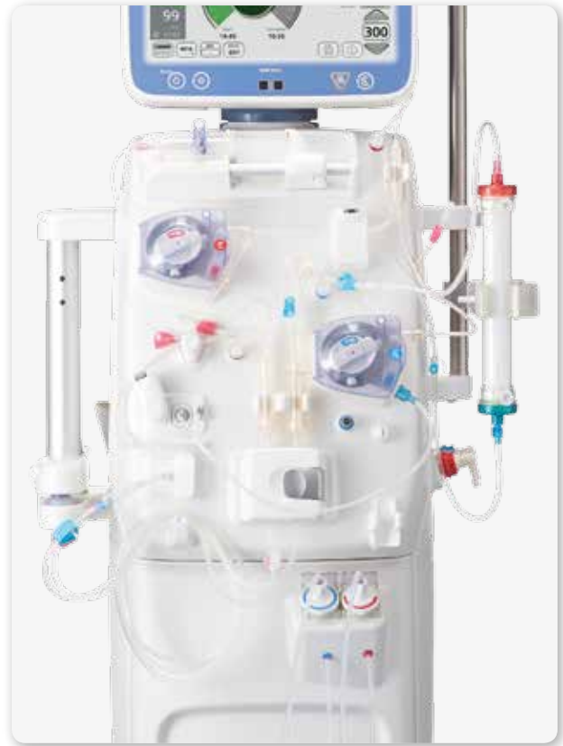
Le circuit sang bien conçu réduit le volume de sang extracorporel et facilite l'installation des lignes à sang.
